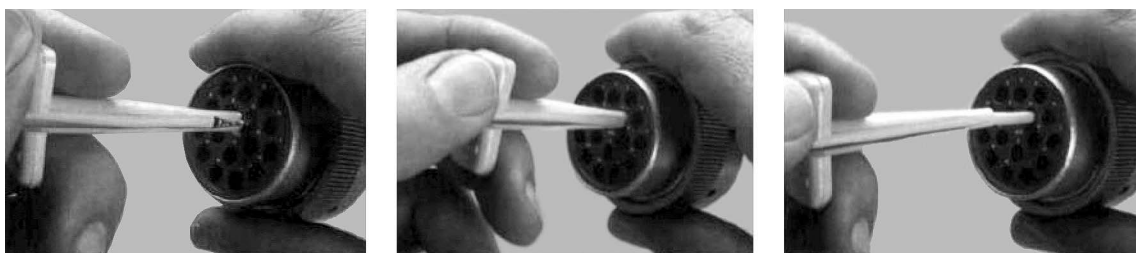
Figura 7-16. Remoção do contato HD/HDP
