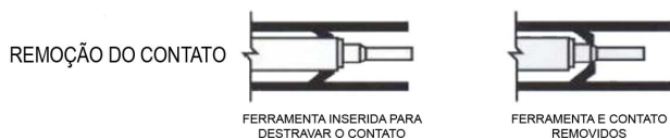
Figura 7-17. Contatos do desbloqueio HD/HDP
