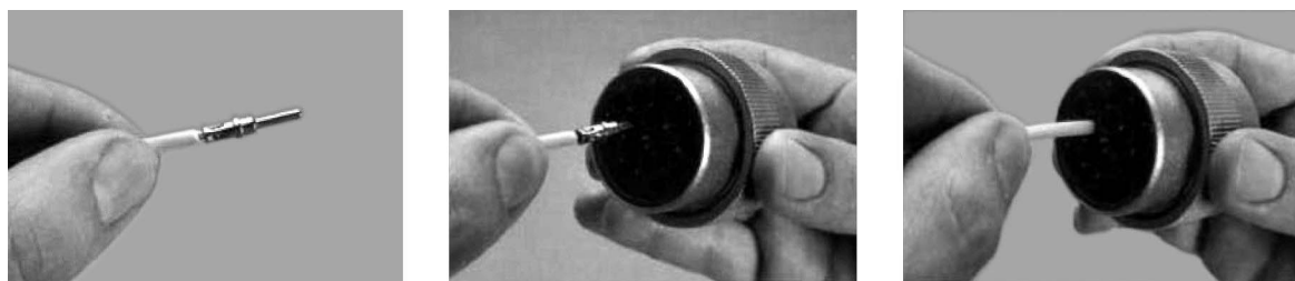
Figura 7-14. Instalação do contato HD/HDP
