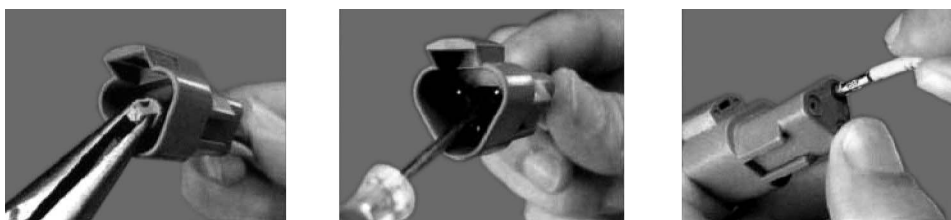
Figura 7-13. Remoção do contato DT/DTP
