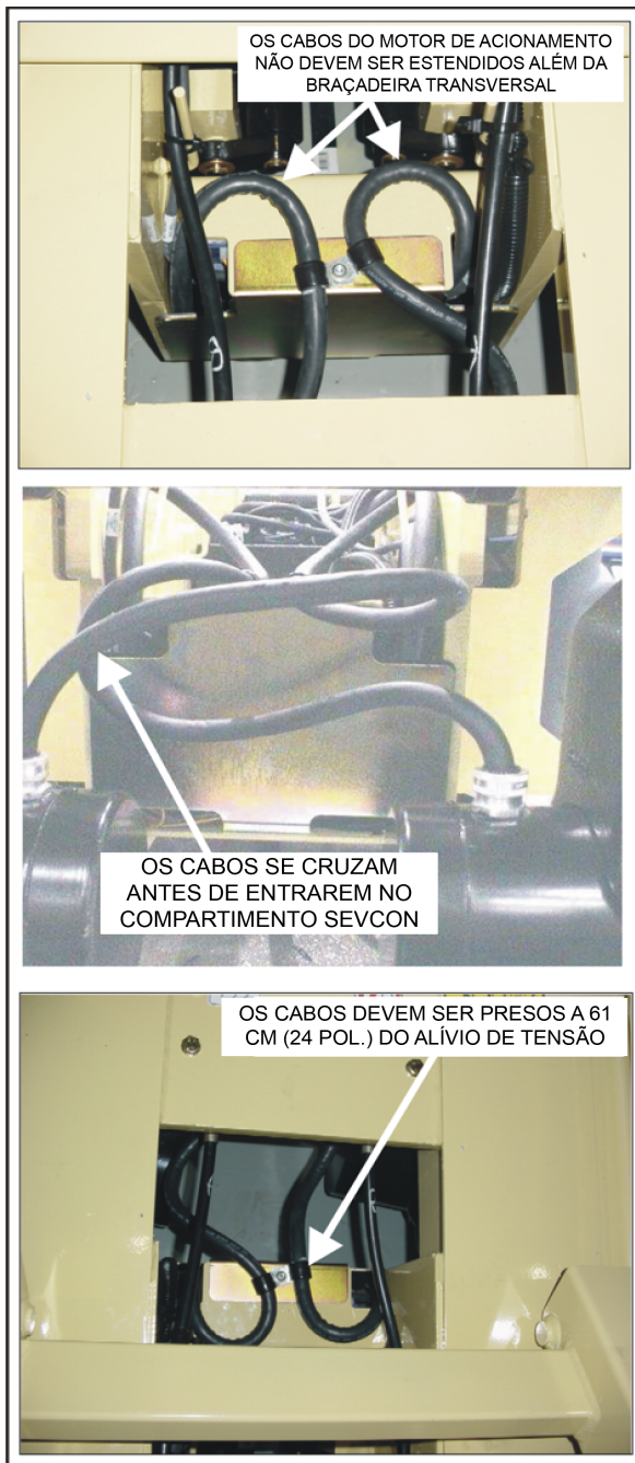
Figura 3-39. Direcionamento do cabo do motor (1930ES)
