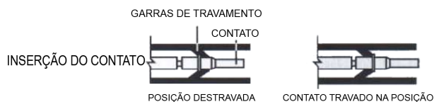
Figura 7-15. Contatos do bloqueio HD/HDP na posição
